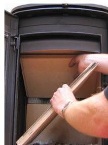
3. Inclinez l'autre brique latérale et retirez-la de la chambre de combustion
