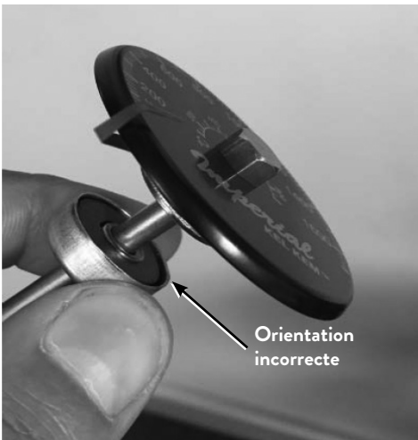
Figure 13c. Retirer l'aimant de l'orientation actuelle
