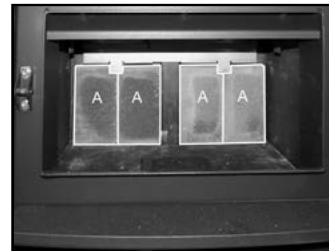
Figure 10: Les autres briques posées sur le mur du fond..
